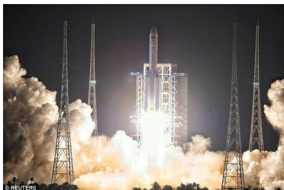
Figure 2 - Le lanceur CZ-5, que l'on voit ici décoller depuis la base de Wenchang, est actuellement le plus puissant de l'arsenal chinois. Il peut placer jusqu'à 25 t en LEO. C'est lui qui a permis de mettre sur orbite les modules de la station spatiale Tiangong-3. ©Reuters
